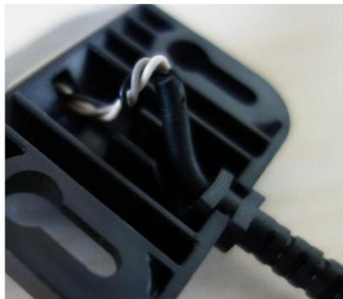
Abbildung 4: Falsche Position von Kabel und Zugentlastung
